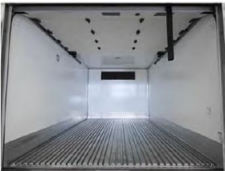
Image 5 : remorques sans buffet et sans mécanisme pour verrouiller les barres de retenue
