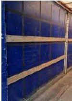
Image 4 : remorques équipées de panneaux latéraux pour verrouiller les barres de retenue
