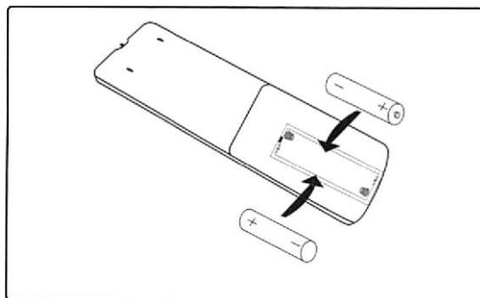
B. Insérer 2 piles AAA conformément au marquage à l'intérieur du compartiment.
