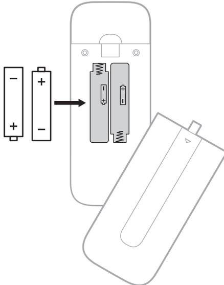
3. Vuelva a deslizar la cubierta del compartimento de las baterías a su lugar.
