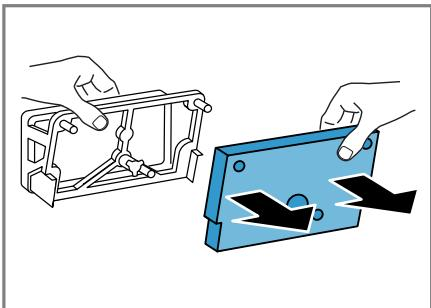
Veillez à ne pas déformer ni endommager le matelas filtrant.
