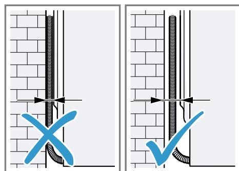
Ne coincer aucun tuyau ni aucun cordeau d'alimentation secteur entre le mur et l'appareil.
