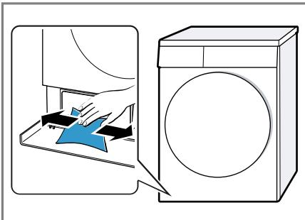
8. Insérez l'insert horizontalement jusqu'à ce que la patte s'enclenche.
