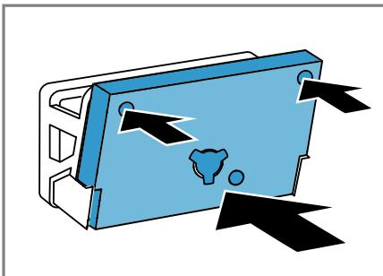
Veillez à ne pas déformer, endommager ni faire glisser latéralement le matelas filtrant nettoyé sur les supports.
