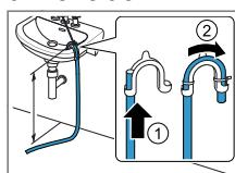
Poussez le tuyau d'évacuation d'eau complètement à travers le coude et fixez-le avec le matériel de fixation.
