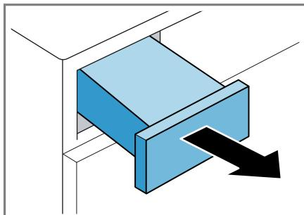
2. Vider le réservoir d'eau de condensation.
