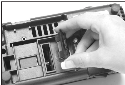
Figure 14. Retrait du couvercle sous la base pour éliminer la poussière de métal (voir la section Entretien normal).
