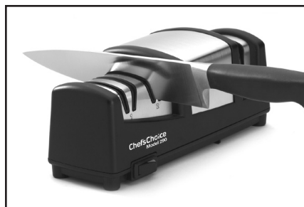
Figura 10. Inserte la hoja en la ranura izquierda de la Etapa 2. Alternar pasando en las ranuras izquierda
