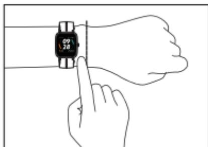
Tragen Sie das Gerät in einem Abstand von einem Finger zum Handwurzelknochen und bringen Sie das Armbanduhr in die Komfortposition.
