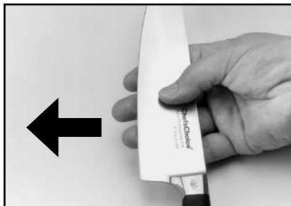
Figure 7 : La bavure peut être sentie en glissant les doigts sur le dessus et en les éloignant du tranchant. Attention ! Voir le texte.
