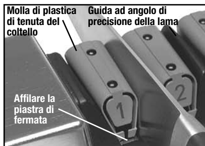
Figura 3. Il coltello viene inserito fra la guida della lama e la molla di tenuta del coltello finché il filo non si appoggia delicatamente sulla piastra di arresto del filo.
