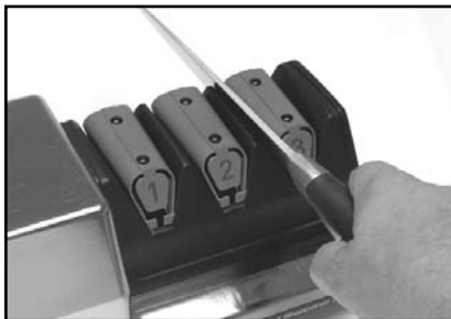
Figura 10. Inserimento della lama nella fessura sinistra della Fase 3. Alternate le fessure sinistra e destra.
