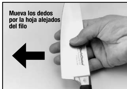
Figura 7: La rebaba puede detectarse pasando los dedos sobre la hoja pero alejados del filo. ¡Precaución! Ver el texto.
