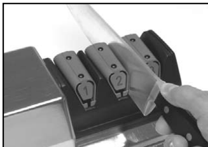
Figure 9 : Insérez la lame dans la fente droite de la phase 2.
