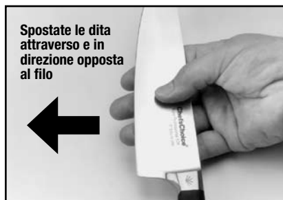
Figura 7. La bava può essere rilevata facendo scivolare le dita attraverso e in direzione opposta al filo. Attenzione! Leggete il testo che si riferisce a questa figura.
