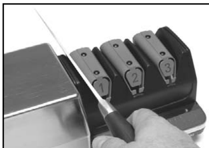
Figura 5: Fase 1. Introducción de la hoja en la ranura entre la guía y el muelle de sujeción del cuchillo. Alternar entre las ranuras izquierda y derecha.
