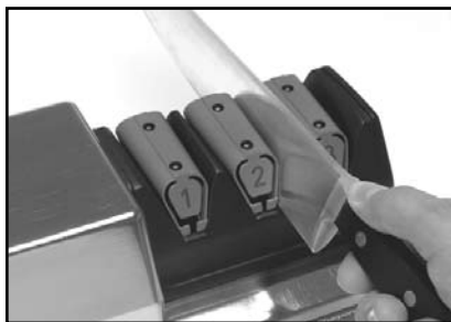
Figura 9: Introducción de la hoja en la ranura derecha en la fase 2.
