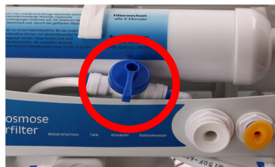
Ventil geschlossen: Normalzustand
