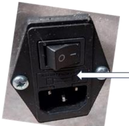
Figure 45 - Hublot avec les fusibles à enlever
