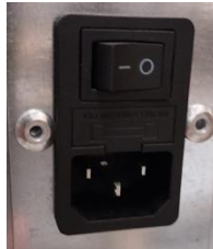
Figure 16 - Prise électrique avec interrupteur général et boîtier Fusibles
