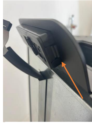
Figure 30 Retrait de l'écran (appuyer sur les leviers latéraux de l'écran)
