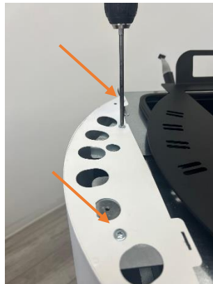
Figure 32 - Retrait des vis du côté
