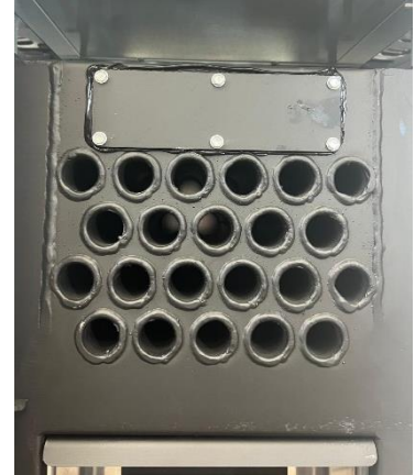
Figure 37 - Vue frontale des échangeurs. Nettoyage avec une brosse
