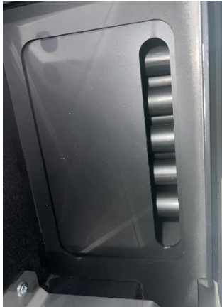
Figure 35 - Passages supérieur des fumées-échangeurs
