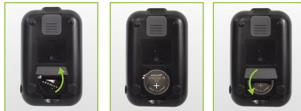
El glucómetro adia solo utiliza una pila de litio de 3V (CR2032), que viene incluida. Al cambiarla, solo se debe usar una pila de litio CR2032 o equivalente.
