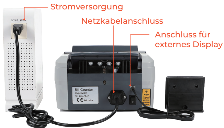
Abbildung 2-1 Anschluss für Stromversorgung und externes Display
