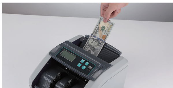
Figure 6-2 Réglage de l'écart d'alimentation avec un billet
