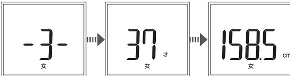
測定結果が順番に表示された後、もう一度体重を表示し、約 40 秒後に自動で電源が切れます。
