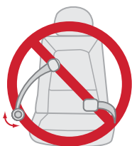
Cinturones de cadera con una placa de cierre cosida que tiene un retractor que se bloquea solo en caso de una parada repentina.
