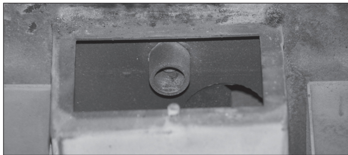
Figure 34 : Éliminer les cendres de tube d'allumeur (sous la boîte à feu)
