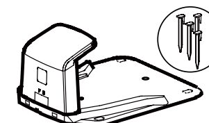
Station de chargement
