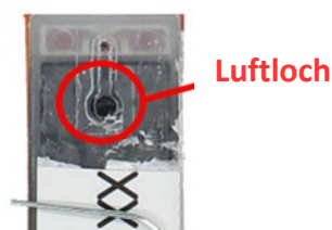
Patrone mit freigelegtem Luftloch
