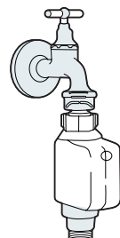
tuyau d'alimentation de sécurité
