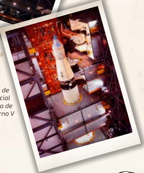
La segunda fase (S-II) se prepara para su acoplamiento a la primera fase (S-IC)
