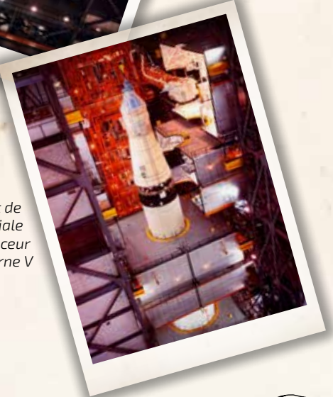
Le deuxième étage S-II est placé en position pour l'accouplement avec le premier étage S-IC
