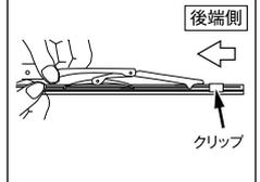
②ワイパーのツメが金属レールの上下のゴムを共に抱え込むように通してください。
