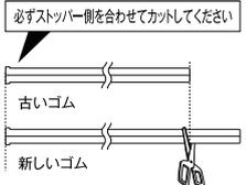
①取り外した金属レールを、図のように新しいゴムに取り付けてください。取り付けの際、金属レールの向き(切り欠きの位置)にご注意ください。
