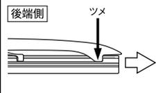
②古いゴムから、金属レールを2本共取り外してください。金属レールは、新しいゴムに同じ向きで取り付けるため、取り付けてあった向きが分かるようにしておいてください。
