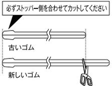
①取り外した金属レールを外した向きと同じ向きで新しいゴムに取り付けてください。
