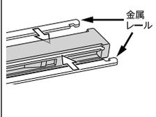
②金属レールを取り付けた新しいゴムを、ワイパー後端側から通し、ゴムのストッパーにツメが入るまでゴムを押し込んでください。(PIAA製ゴムのストッパーと純正ゴムのストッパーは位置が異なります)
