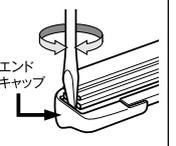
マイナスドライバー等を使用し、ストップバーのツメ部を押し上げて、ゴムを引き抜き取り外してください。
