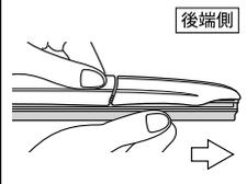
②古いゴムから、金属レールを2本共取り外してください。金属レールは、新しいゴムに同じ向きで取り付けるため、取り付けてあった向きが分かるようにしておいてください。
