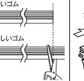
カットした新しいゴムを金具に差し込み、後端部までスライドさせてください。
