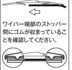
③取り付けの途中、下図のようにワイパーのツメが金属レールとゴムとの間に入ってしまうことがあります。これは正確な取り付けではありません。この場合、ゴムを⇩ 方向に押し上げながら、⇨ 方向に動かし、正しい位置に直してください。
