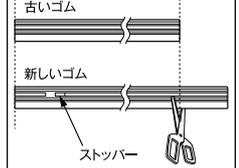
①新しいゴムのストップバーがない側から、ワイパーの後端側の樹脂キャップとワイパー本体の間に通してください。
