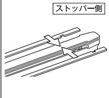
②金属レールを取り付けた新しいゴムをワイパー後端側から各ツメに通し、ゴムのストッパー穴にツメが入るまでゴムを押し込んでください。
