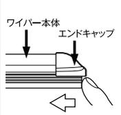
ゴムが動かない側のエンドキャップに、マイナスドライバー等を用いて、左右に回して、取り外してください。
