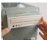
光学ドライブの取り付け
