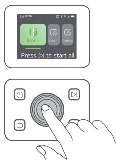
3. Wählen Sie durch Drehen des Drehschalters den gewünschten Mähmodus aus.
