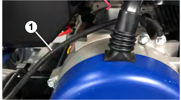
Figura 5 - Ubicación del cable negativo (-)
