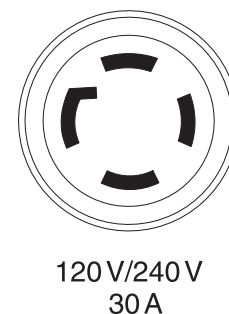
Schéma 12 - Prise 120/240 V c.a., 30 A
