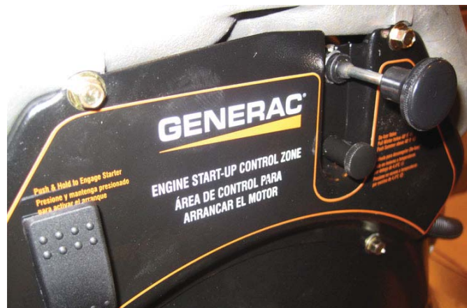
Figura 19 - Posición Full Choke
