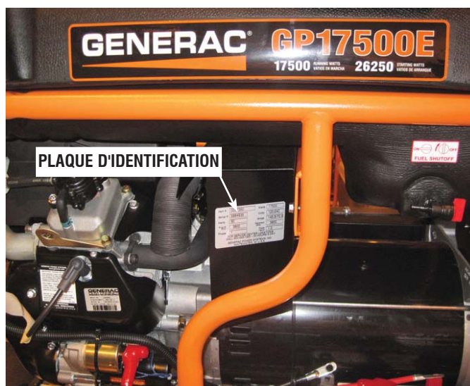
Schéma 1 - Plaque d'identité du générateur
