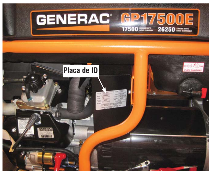
Figura 1 - Paca de ID del generador
