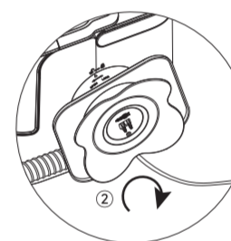
3. Alignez le support du cordon/tube avec l'icône du corps principal, enclenchez-le horizontalement, puis tournez dans le sens horaire pour verrouiller. Le bruit d'un déclic indique une installation correcte.
